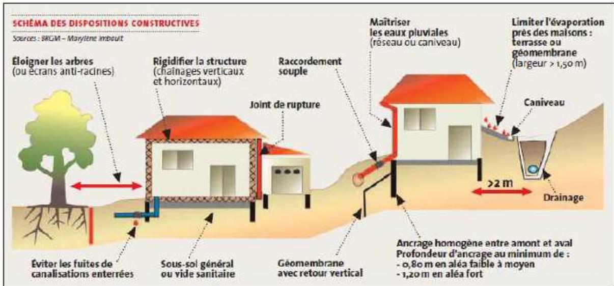
Tableau 9 : Schéma synthétique des dispositions constructives (www.georisques.gouv.fr)
